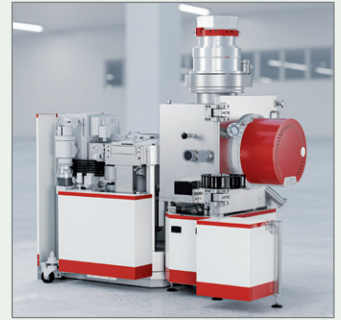
scia Mill 200 – Produktionssystem zur ionenstrahlbasierten Strukturierung von TMR-Sensoren.
