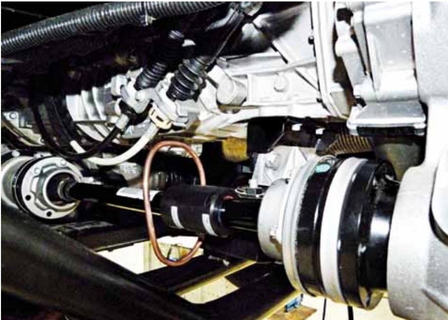
▲ Installiertes Leistungsmesssystem mit induktiver Spannungsversorgung am Fahrzeug.
