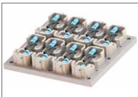
▲ Der Testaufbau für den Vibrationstest entstand nach aufwendigen FEM-Simulationen und mehreren Designphasen.
