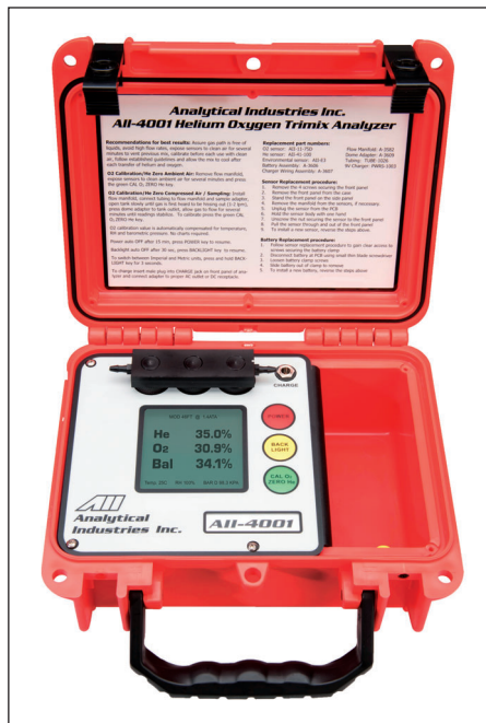
▲ Elektrochemische Sensoren für Sauerstoff.
