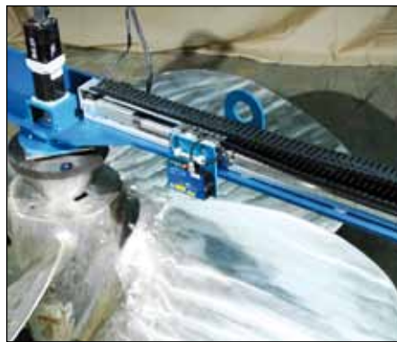
▲ Profilmessung der Schaufeln einer Schiffsschraube. Quelle: Propstraightener.com
