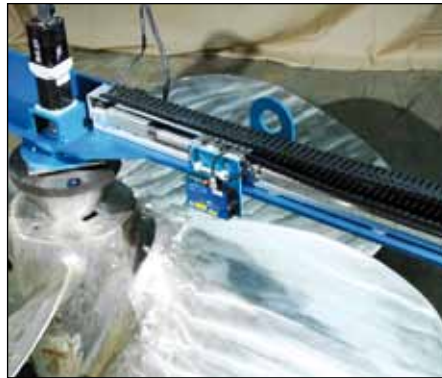
▲ Profilmessung der Schaufeln einer Schiffsschraube. Quelle: Propstraightener.com
