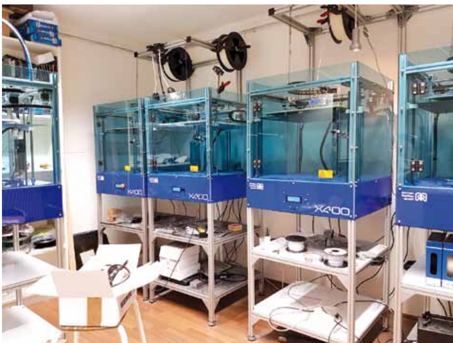
▲ Fünf German RepRap X400 bei der Serienproduktion.
