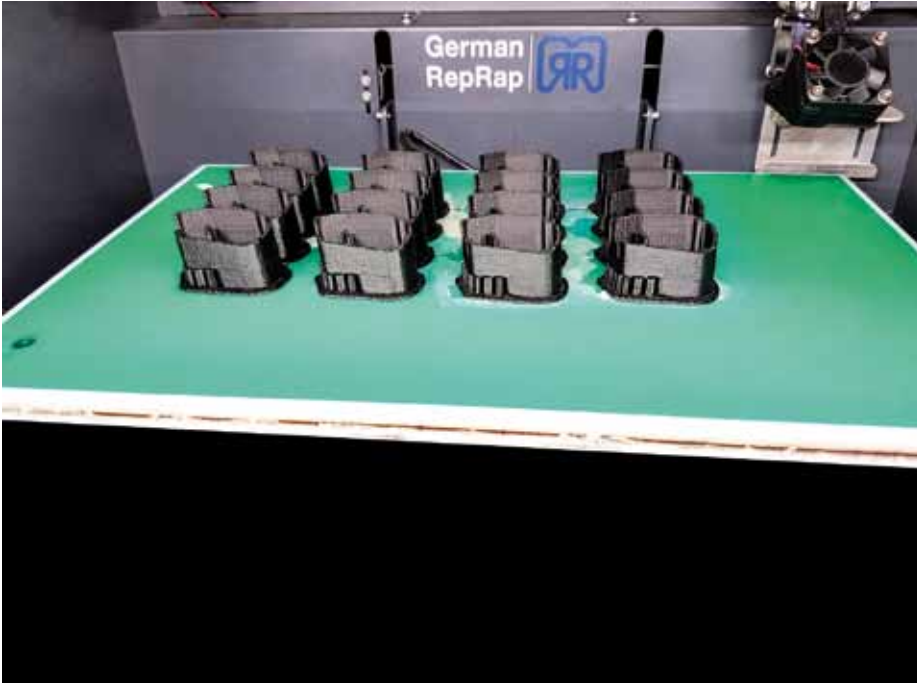
▲ Der German RepRap X350 bei der Serienproduktion von 16 Teilen gleichzeitig.
